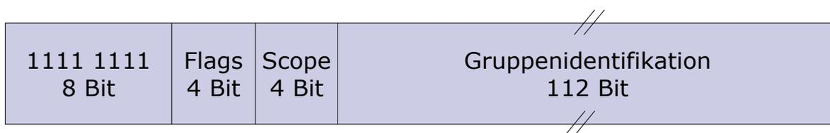
Abb. 3: Aufbau einer IPv6-Multicast-Adresse
